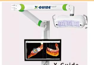
手術中にドリルの位置をリアルタイムに追跡するダイナミック3Dナビゲーション・システムです。インプラント埋入方向、角度、そして深さの精度と正確性を向上させることができます。
